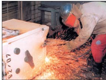
Abb. Prüfmethode mit Schneidbrenner Prüfmethode mit Diamantkronenbohrer
