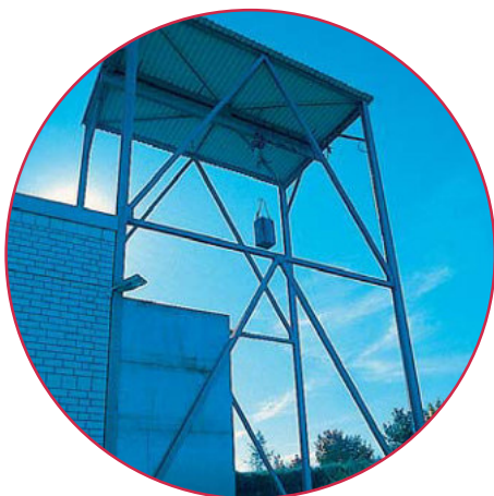
FORMAT Tresor Sturztest aus einer Höhe von 9,15m FORMAT drop test tower with a high of 9,15m
